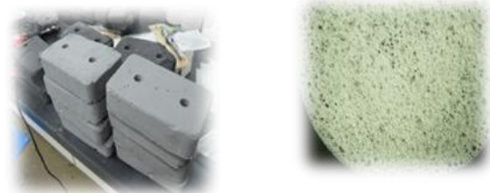
写真1 二価鉄-フルボ酸錯体溶出ブロック（左）およびPLA(ポリ乳酸) 発泡バインダー(右)
